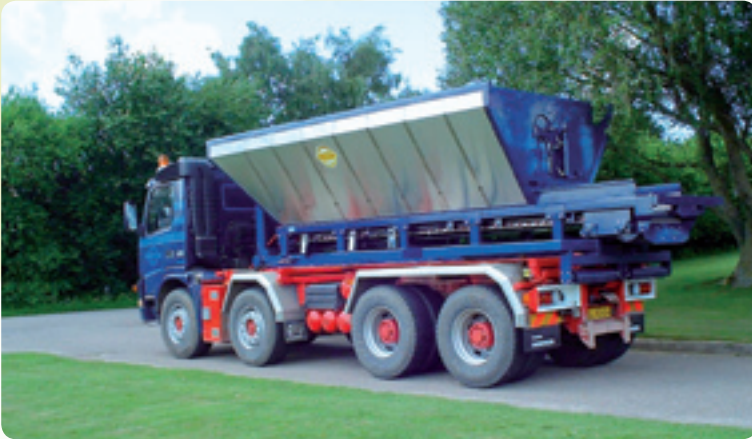
Izoliuotas Bredal K125 agregatas (asfalto transportavimui)
