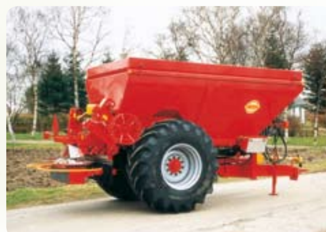
K105 с гуми 800/65 x 32 tyres, бункерно разширение, хидравлично управление на дозирането, задействан от предвката резерв и оборудване за варовик 12-16 м /за тор 12-24 т.
