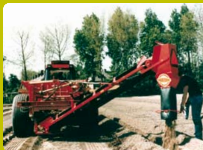
Разпръсквач за пясък Bredal. За монтиране върху тип K45-K105.
