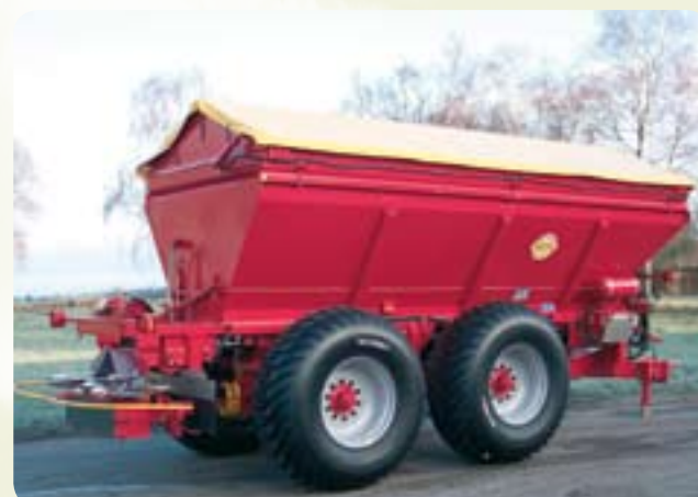
K135 с гуми 650/65 x 30,5, оборудване за варовик 12-16 м /за тор 12-24 т и бункерно разширение с хидравличен капак. Стандартно K135 идва с хидравлично управление на дозирането чрез компютър Bredal LH500.
