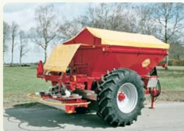
K45 с гуми 16,9 x 30, оборудване за тор 12-36 т, бункерно разширение, капак върху разпръсквачката система и хидравлично управление на дозирането.
