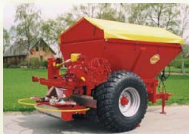
K45 с гуми 16,9 x 30, оборудване за тор 12-36 т, бункерно разширение, капак върху разпръсквачката система и хидравлично управление на дозирането.
