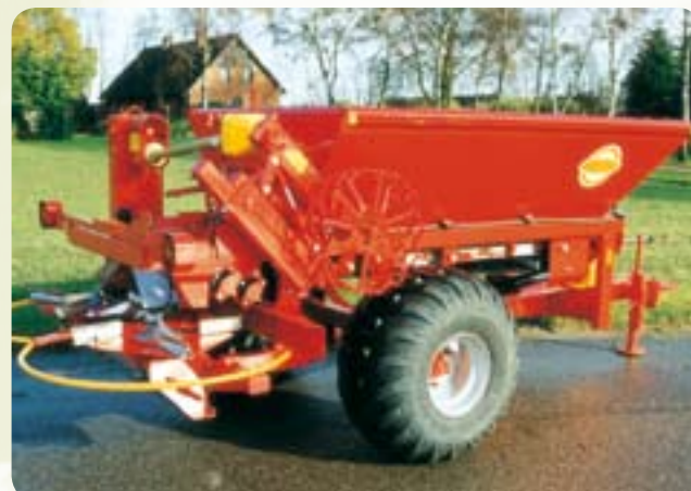
K40 с гуми 425/65 x 22,5, оборудване за варовик 12-16 м /за тор 12-24 т.
