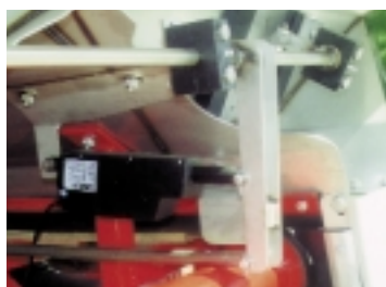
Moteur électrique pour le réglage des trappes arrière.
