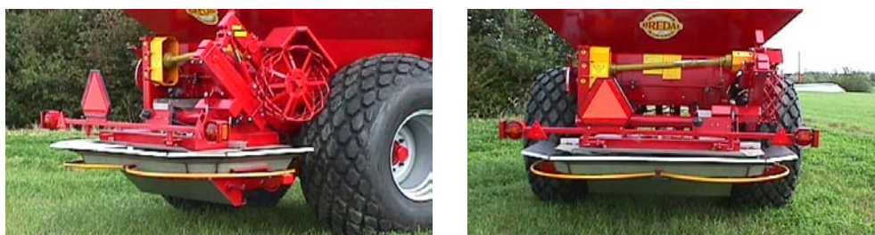
Fig. 13. Wyposazenie do nawozenia poznego zamontowane na rozsiewaczu Bredal do nawozu mineralnego typ B8.
